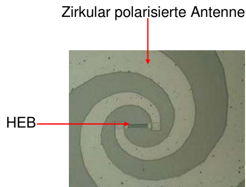
Abbildung 6.11: Aufbau des Thermistors. Der Thermistor besteht aus einer Antenne und dem eigentlichen HEB als Verbindungsstück. (Abbildung aus [70])
